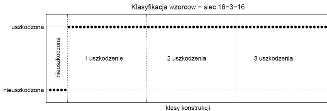
Rys. 3. Rezultat wykrywania anomalii w paśmie aluminium przez sieć neuronową 16-3-16.
