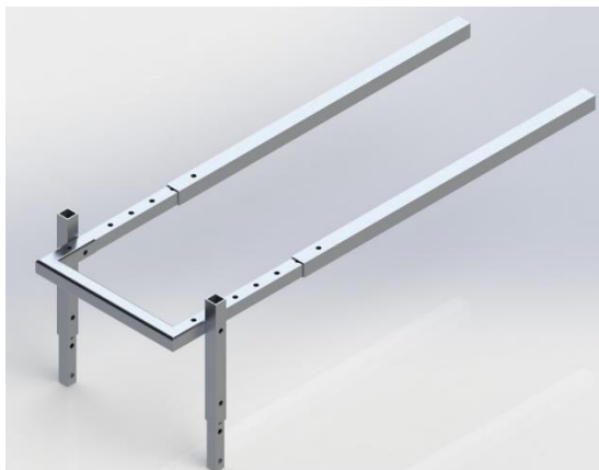
Rys. 4. Początkowy projekt ramy wózka inwalidzkiego Źródło: Opracowanie własne
