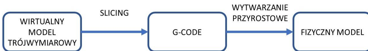
Rys. 22. Etapy procesu druku 3D Źródło: opracowanie własne
