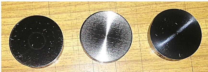
Rys. 2.10. Zdjęcie próbek po próbach tarcia na testerze T-11; od lewej: próbka po szlifowaniu, próbka po polerowaniu, próbka po docieraniu [2]
