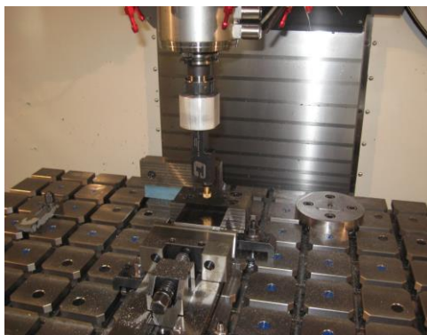
Rys. 6.2. Zdjęcie głowicy nagniatającej DB-3 i próbki zamocowanych na tokarce VF-2SS [5]
