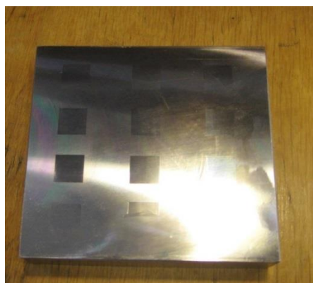
Rys. 8.1. Próbkę po obróbce nagniataniem [5]
