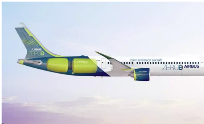
Rys. 9. Rys.7. Koncepcja samolotu zasilanego wodorem firmy Airbus [2]
