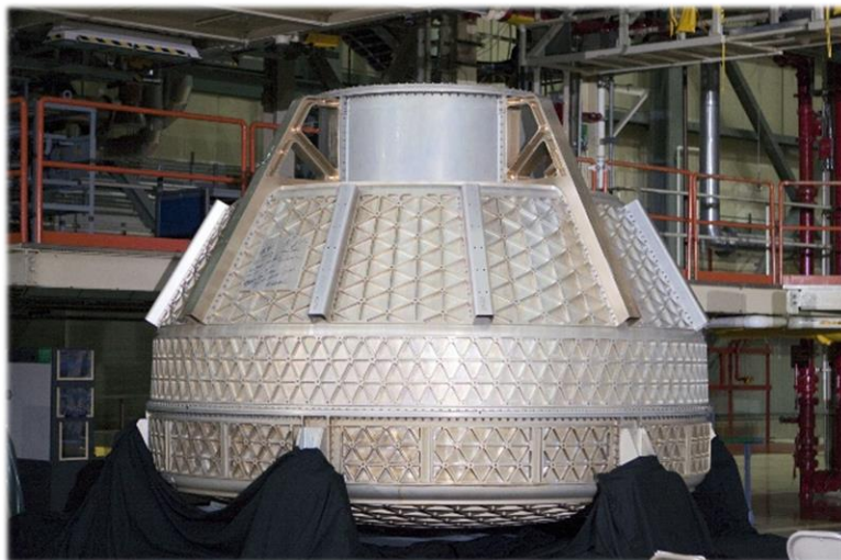
Rys. 5.3. Przykład zastosowania struktur typu isogrid w konstrukcji statku kosmicznego Boeing CST-100 Orion (fot. NASA)
