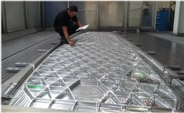
Rys. 5.2. Przykład zastosowania usztywnień w postaci siatki trójkątnej w konstrukcji żeber skrzydła samolotu A330 neo (fot. Airbus)
