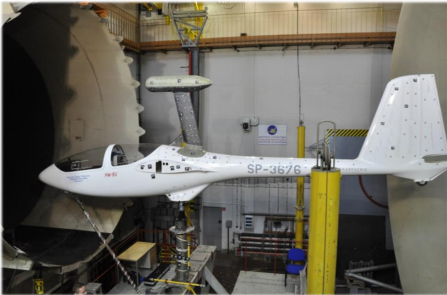
Rys. 6.25. Badany szybowiec zamontowany w przestrzeni pomiarowej tunelu aerodynamicznego
