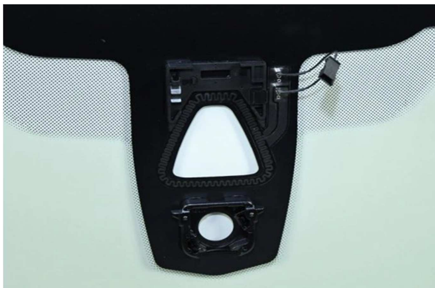
Rys. P11.1. Okienko kamery z zamontowanym braketem
