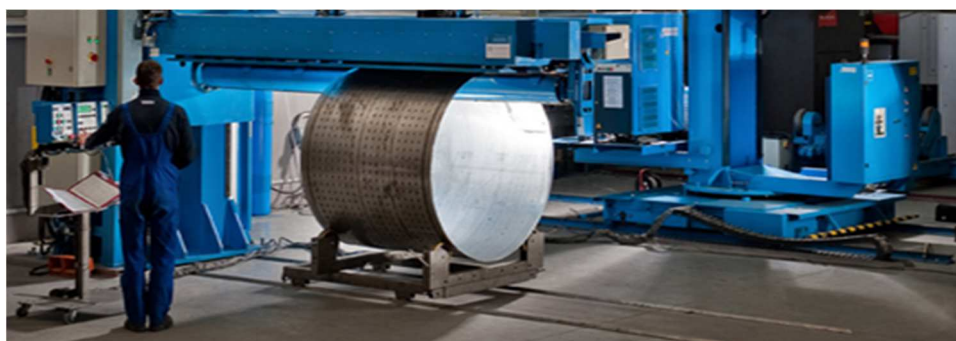
Rys. P19.2. Urządzenie Nertamatic podczas procesu spawania PAW
