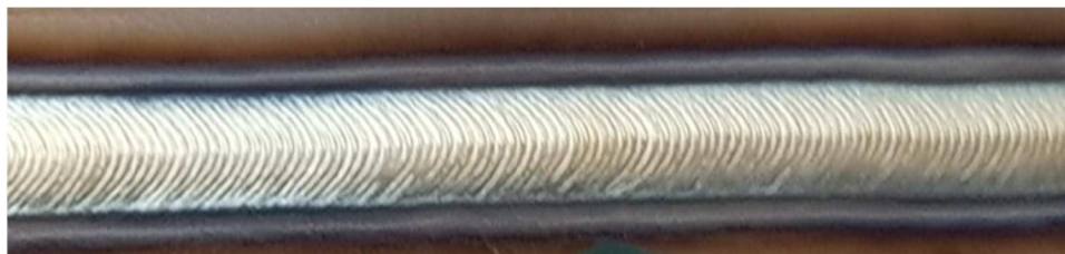
Rys. P19.4. Lico spoiny 2. wykonanej metodą PAW przed czyszczeniem, za pomocą zakupionego urządzenia Nertamatic 450
