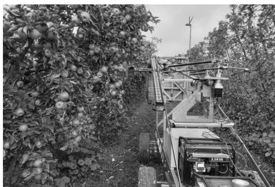
Rysunek 21 Zdjęcie: Robot do zbierania jabłek, element robota odpowiedzialny za zbior
