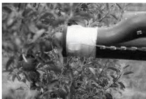
Rysunek 20 Zdjęcie: Robot do zbierania jabłek, element robota odpowiedzialny za zbiory Źródło: https://kobietawsadzie.pl/sam-zrywa-i-pakuje-jablka-zobacz-robota-przyszlosci/
