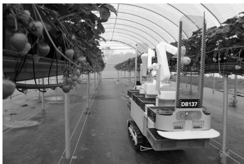
Rysunek 23 Zdjęcie: Robot do zbierania truskawek. Zdjęcie pokazuje jego wygląd i budowę Źródło: https://www.sadyogrody.pl/agrotechnika/103/au
