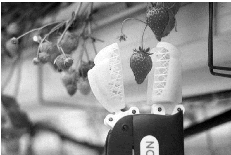
Rysunek 25 Zdjęcie: Uchwyt robota do zbierania upraw, plastikowy element łapiący owoce Źródło: https://www.sadyogrody.pl/agrotechnika/103/aut
