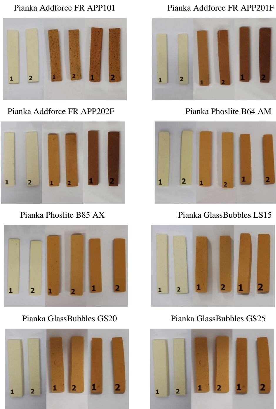
Rys. 6. Fotografie kształtek przed badaniem, po 20 oraz 40 godz. wygrzewania w temp. 150 C. Oznaczenia: 1, 2 – kompozycja z udziałem odpowiednio: 30% i 60% wypełnienia.
