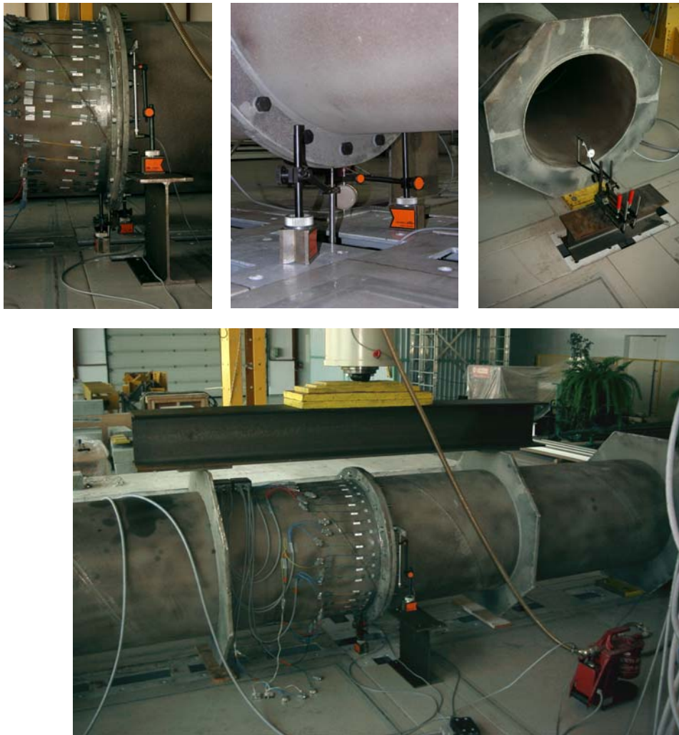
Rys. 5. Element do badań doświadczalnych z czujnikami indukcyjnymi i tensometrycznymi
