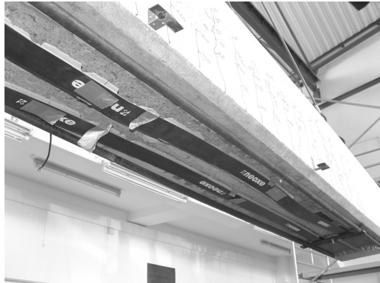
Rys.2. Badania belki wzmocnionej sprężonymi taśmami CFRP - Politechnika Rzeszowska
