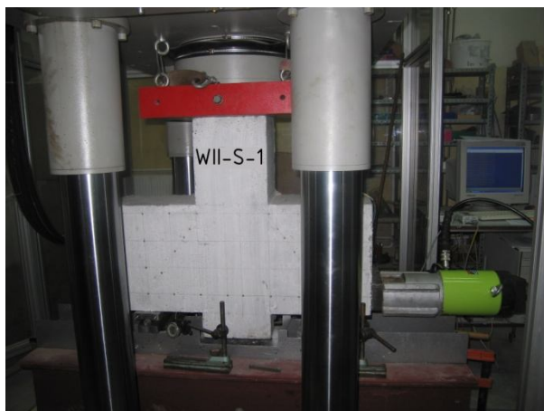
Rys. 4. Wspornik WII-S-1 na stanowisku badawczym w trakcie sprężania
