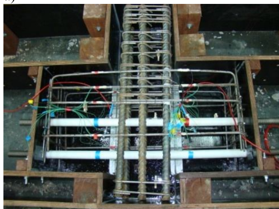
Rys. 3. Zbrojenie wspornika przygotowane do betonowania: a) WII-S-2, b) WII-SD-2
