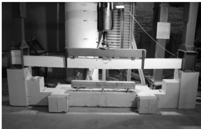
Rys. 6. Widok stanowiska badawczego belek w skali naturalnej ze zbrojeniem mieszanym
