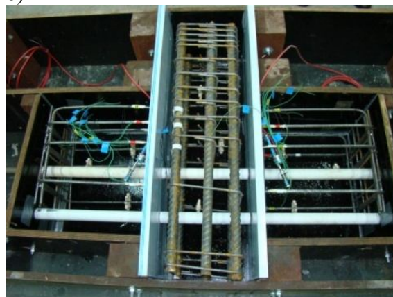
Rys. 3. Zbrojenie wspornika przygotowane do betonowania: a) WII-S-2, b) WII-SD-2
