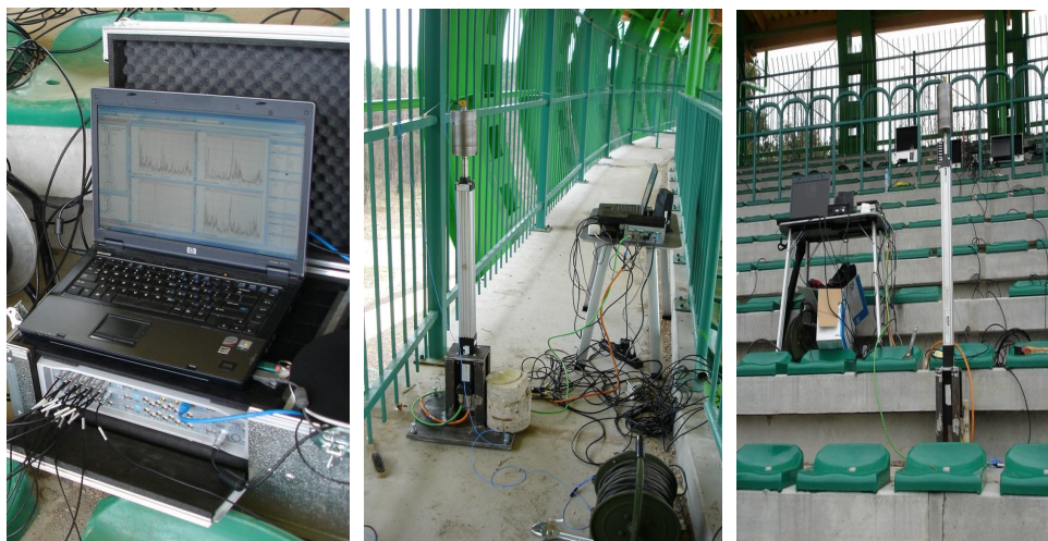
Rys. 3. Aparatura pomiarowa oraz wzbudnik w ustawieniu nr I i w ustawieniu nr II
