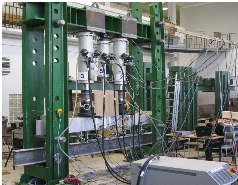
Rys. 3. Stanowisko badawcze (3 i 2 – siłowniki obciążające) wraz z czujnikami
