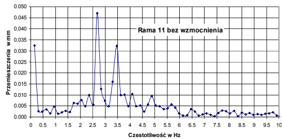
Rys. 13. FFT sygnału wzbudzonego dźwigara nr 11
