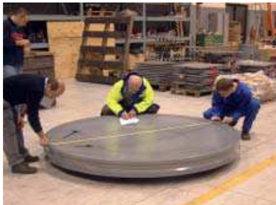
Rys. 9. Łożysko przewidziane na most w Płocku podczas pomiarów w wytwórni
