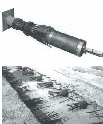
Rys. 2. a) Siłownik do sprężania kabli wykonanych z drutów równoległych o sile 20 ton, b) widok zakotwień po sprężeniu, c) schemat siłownika do sprężania z blokadą hydrauliczną i zakotwień kabli.
