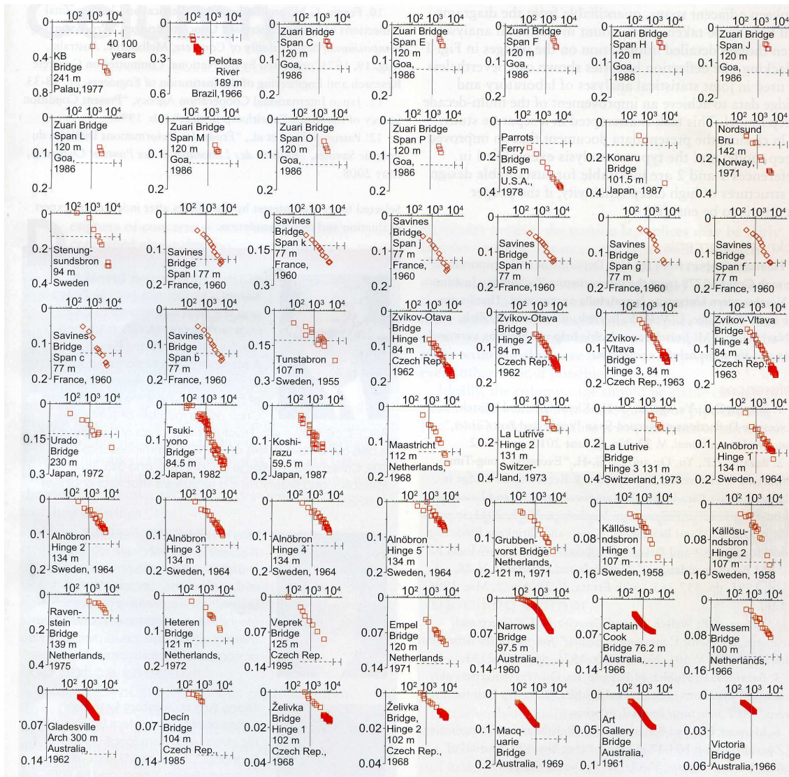
Rys. 7. Przemieszczenia pionowe środka rozpiętości przęseł 56 mostów (dodatkowy opis – rys. 5) [17].
