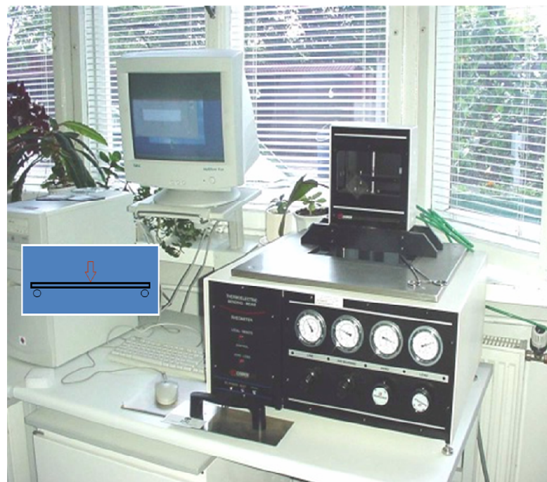
Fot. 4. Aparat BBR (Bending Beam Rheometer) - odporność niskotemperaturowa
