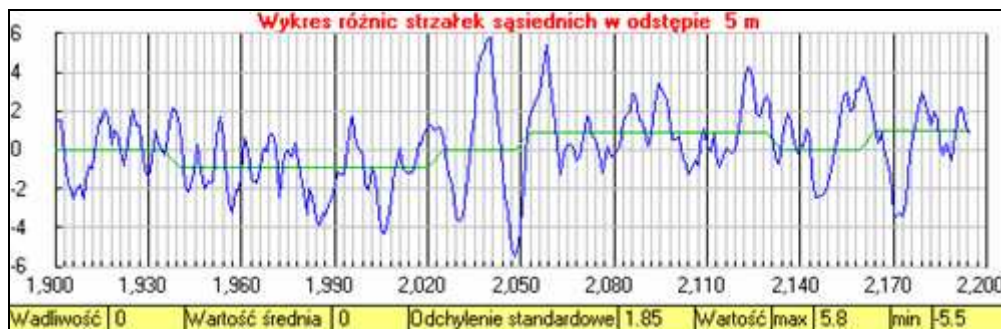
Rys. 4. Różnica sąsiednich strzałek pomierzonych w łuku o promieniu R = 830 m
