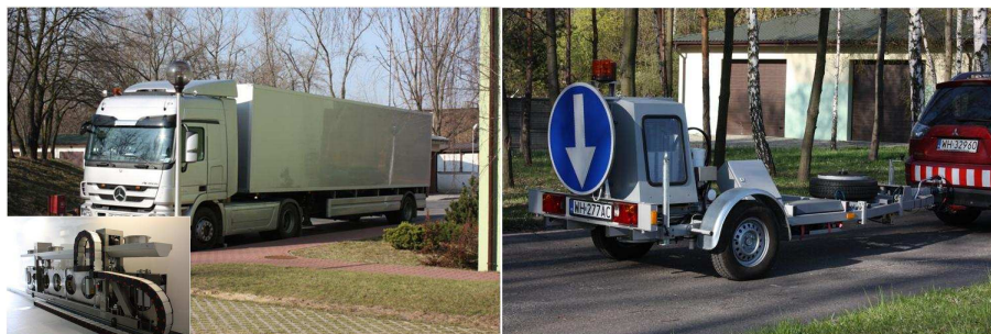
Fot. 8. Ugięciomierz laserowy TSD oraz ugięciomierz FWD
