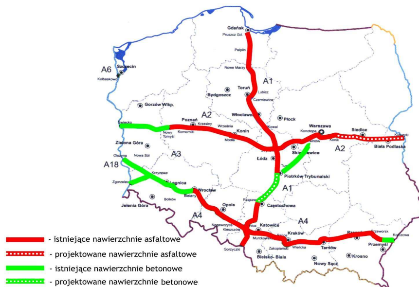
Rys. 2. Rodzaje nawierzchni na autostradach w Polsce
