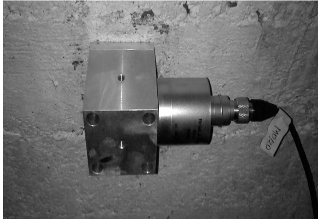
Rys. 3. System mocowania akcelometrów DeltaTron 8340
