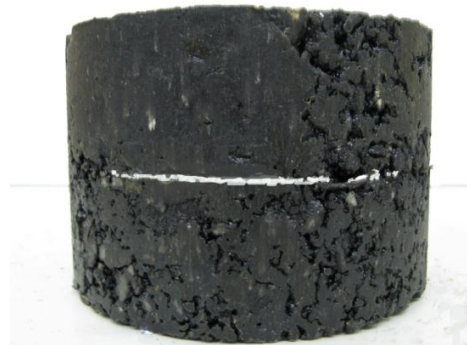
Rys. 5. Seria próbek przygotowanych do badań oraz widok pobocznic próbki z zaznaczoną powierzchnią połączenia międzywarstwowego
