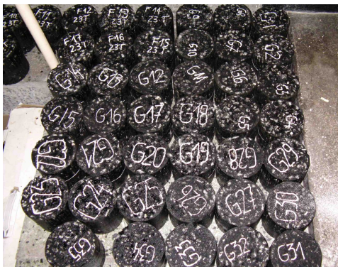
Rys. 5. Seria próbek przygotowanych do badań oraz widok pobocznic próbki z zaznaczoną powierzchnią połączenia międzywarstwowego
