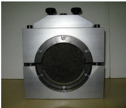
Rys. 1. Aparat Leutnera (a) i stanowisko do badań zmęczeniowych ścinania (b)
