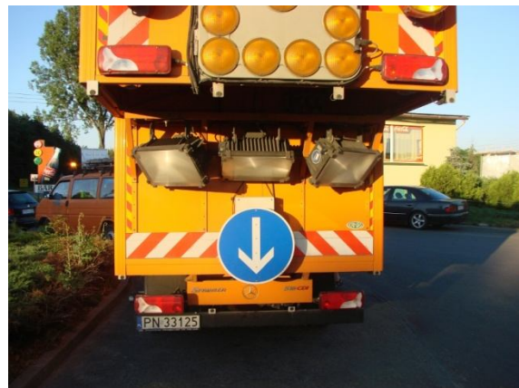
Rys. 1. Pojazd pomiarowy ZEUS firmy Lehmann + Partner jako przykład wielofunkcyjnego pojazdu wykorzystywanego do badań stanu nawierzchni jezdni (źródło: Lehmann + Partner, materiały własne)
