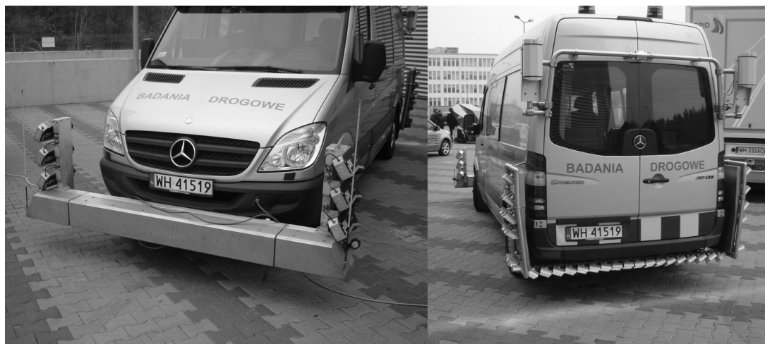
Rys. 1 Pojazd pomiarowy z profilografami i rejestratorem wizyjnym stanu nawierzchni
